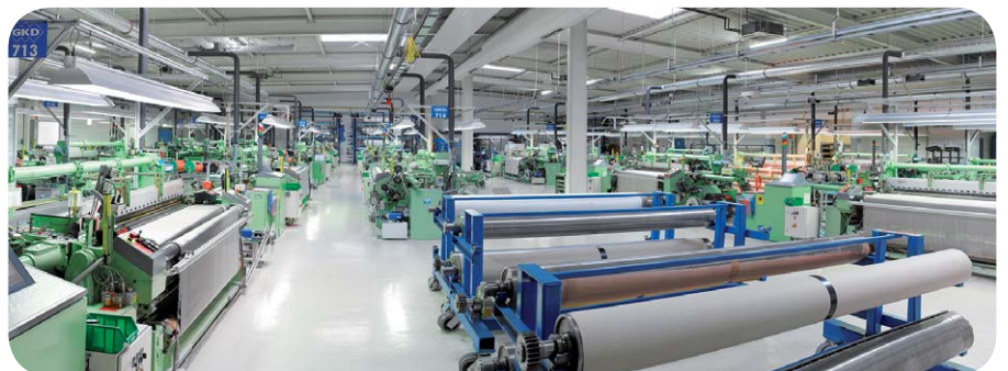
Fast alle Maschinen und Anlagen in der Metallgewebe-Produktion von GKD benötigen Druckluft als Energie und/oder Transportmedium.
