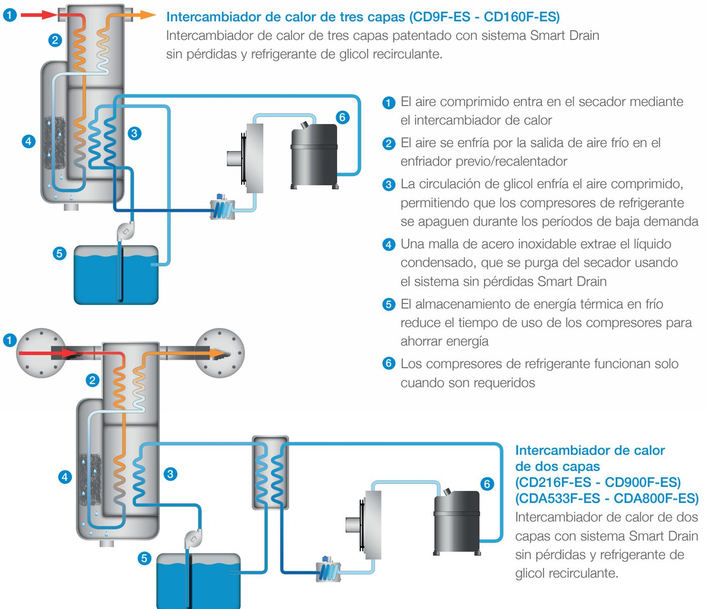
“ Los secadores frigoríficos de CompAir proporcionan la combinación perfecta de alta eficiencia, baja caída de presión y tamaño reducido.
