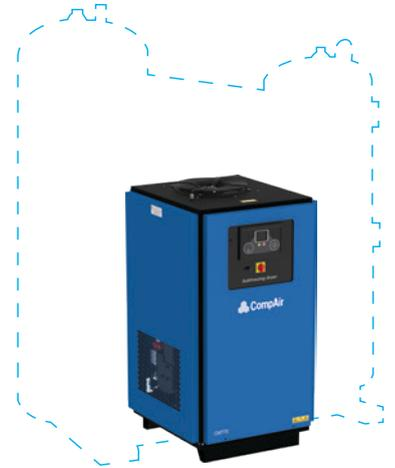
**ESSICCAZIONE:** con solo il 15% di umidità rimanente, l'aria entra quindi nello scambiatore di calore dell'essiccatore sotto zero dove viene raffreddata ed essiccata a un PDP di -20 °C (-4 °F). L'umidità rimossa forma un sottile strato di brina sulle pareti interne dello scambiatore di calore.
